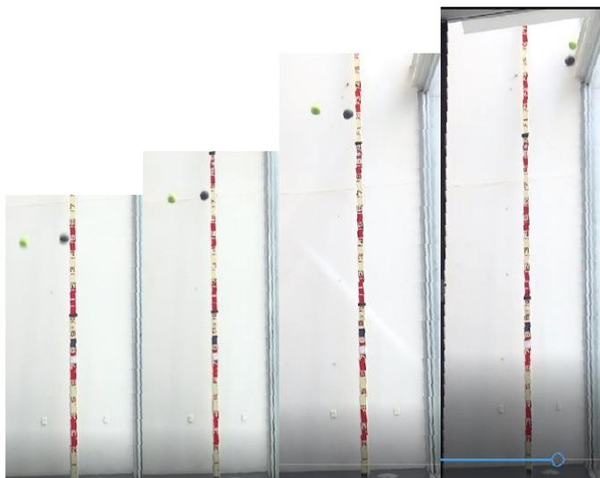
図 2 2m~5m の定点落下反発試験の画像
